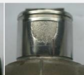
Obserwacja makroskopowa krzyżaka wału napędowego po testach dynamicznych zgodnie z systemem kontroli jakości producenta - widoczne efekty pittingu
