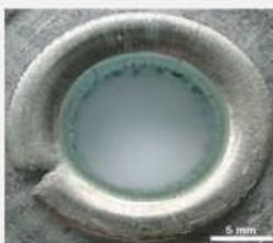
Obserwacja makroskopowa obszaru przełomu i pęknięcia nitów
