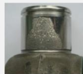
Obserwacja makroskopowa krzyżaka wału napędowego po testach dynamicznych zgodnie z systemem kontroli jakości producenta - widoczne efekty pittingu
