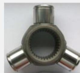
Obserwacja makroskopowa krzyżaka wału napędowego po testach dynamicznych zgodnie z systemem kontroli jakości producenta - widoczne efekty pittingu
