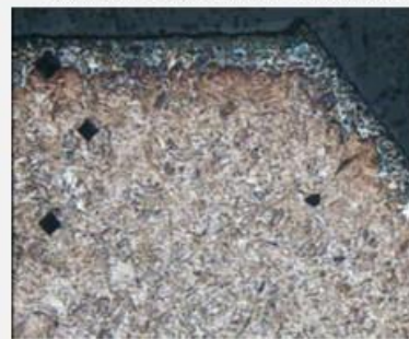
Analiza mikrostruktury stali niskostopowej 20MnCr5 - widoczne wady po procesie nawęglania / siatka ferrytowa na górnej powierzchni krzyżaka / źle dobrana prędkość przechłodzenia podczas nawęglania
