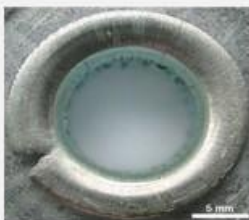
Obserwacja makroskopowa obszaru przełomu i pęknięcia nitów
